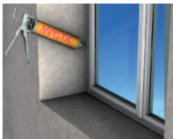
Amélioration de l'étanchéité
